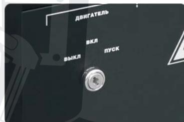
(c) Установите выключатель в положение «ВЫКЛ».
