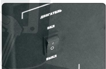
(c) Установите выключатель в положение «ВЫКЛ».
